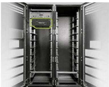
Montez le premier module de batterie dans les glissières en dessous de l'APU HV1000-S. Fixez-le à l'aide de quatre vis à tête plate M6 x 16 (I) (cruciforme) avec rondelles en plastique (II) aux écrous cage préinstallés. Montez les modules restants dans la moitié gauche de l'armoire. Si 16 modules de batteries sont utilisés, la position la plus basse est également occupée.
