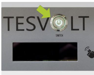
Appuyez maintenant sur le commutateur d'arrêt et de marche « SWITCH » (17) sur l'APU HV1000-S. Le voyant LED vert doit ensuite s'éteindre.
