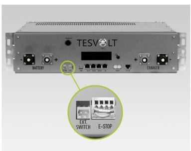
La fiche à quatre broches pour le branchement E-Stop sur l'APU HV1000-S doit être branchée pour assurer le fonctionnement. Sans cette fiche, l'APU HV1000-S reste inactive. Pour obtenir plus d'informations sur E-Stop, consultez la section « 6.3 Contact E-Stop », page 31.
