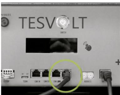
Établissez la **connexion LAN** (9) de l'APU HV1000-S au moyen du câble de connexion (7.4) à l'un des deux switches fournis par TESVOLT (8) via la prise femelle étiquetée « LAN ». Ce switch est relié via la prise femelle « LAN 2 » de SMA Inverter Manager (10) et apparaît désormais sous la désignation « LAN 2 Switch ». Le SMA STPS 60 y est également connecté (voir section « 7 Connexion à l'onduleur de batterie », page 33 et suivantes).
