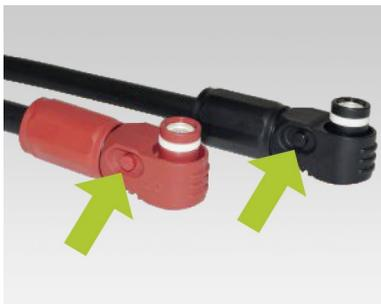
Lors de l'installation des câbles DC, tenez compte des points suivants : **les fiches doivent être enclenchées de manière audible**. Les fiches peuvent être déverrouillées à l'aide du bouton poussoir situé sur le côté de la fiche (voir marquages dans l'illustration).
