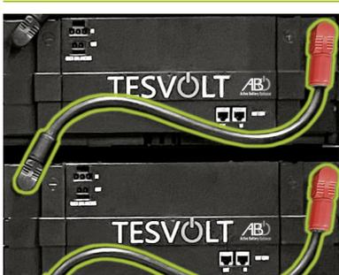
Installez les câbles de raccordement DC restants (4.1) entre les modules du côté droit. Commencez par le module situé le plus en bas.
