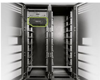
Coloque el primer módulo de batería en los carriles de deslizamiento debajo de la APU HV1000-S. Fíjelo con ayuda de cuatro tornillos de cabeza plana M6 x 16 (I) (Phillips) incl. arandelas de plástico (II) a las tuercas enjauladas montadas de fábrica. Ahora monte los módulos restantes en la mitad izquierda del armario. Al usar 16 módulos de baterías también se ocupa la posición más baja.
