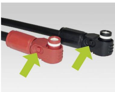
Al montar el cableado de CC, asegúrese de lo siguiente: **los conectores deben encajar de forma audible.** El conector puede desbloquearse con el botón situado en el lateral del conector (véanse las marcas en la figura).
