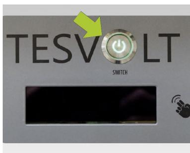
Pulse el interruptor de encendido-apagado "SWITCH" (17) en la APU HV1000-S. Después tiene que apagarse el LED verde.
