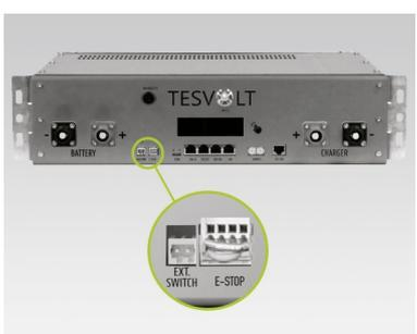
El conector de 4 polos para la conexión de parada de emergencia en la APU HV1000-S tiene que estar enchufado para su funcionamiento. Sin este conector, la APU HV1000-S permanece inactiva. Encontrará más información acerca de la parada de emergencia en el apartado "6.3 Contacto de parada de emergencia" en la página 31.
