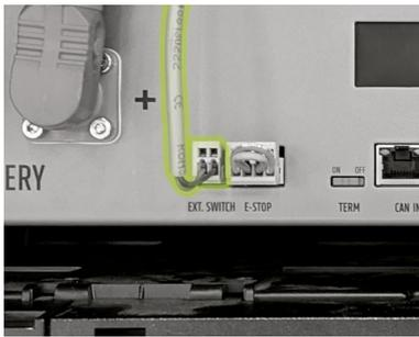
Conecte el conector del cable de conexión **E** en la conexión "EXT. SWITCH" **3** en la APU HV1000-S.
