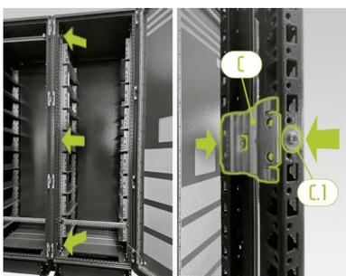
En primer lugar, coloque tres herrajes de montaje en la parte delantera del armario **H** en los perfiles centrales verticales del armario en la parte interna superior, central e inferior del armario. Los herrajes de montaje se fijan a los perfiles del bastidor con dos tornillos de vástago cada uno **H.1** por la derecha y por la izquierda.
