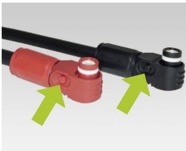
Bei Montage der DC-Verkabelung achten Sie bitte darauf: **Die Stecker müssen hörbar einrasten.** Die Entriegelung der Stecker ist über den seitlichen Druckknopf am Stecker möglich (siehe Markierungen in der Abbildung).
