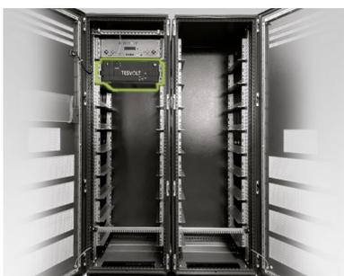
Setzen Sie das erste Batteriemodul in die Gleitschienen unterhalb der APU HV1000-S ein. Befestigen Sie es mit Hilfe von vier Flachkopfschrauben M6 x 16 (I) (Kreuzschlitz) inkl. Kunststoff-unterlegscheiben (I.I) an den vormontierten Käfigmuttern. Montieren Sie jetzt die übrigen Module in der linken Schrankhälfte. Bei Ver-wendung von 16 Batteriemodulen wird auch die unterste Position besetzt.
