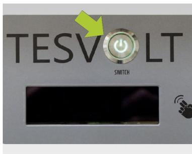
Jetzt den Ein-Aus-Schalter „SWITCH“ **17** an der APU HV1000-S betätigen. Die grüne LED muss danach erlöschen.
