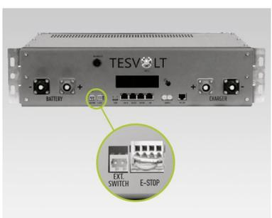
Der 4-polige Stecker für den E-Stop-Anschluss an der APU HV1000-S muss für den Betrieb gesteckt sein. Ohne diesen Stecker bleibt die APU HV1000-S inaktiv. Weitere Informationen zum E-Stop finden Sie im Abschnitt „6.3 E-Stop-Kontakt“ auf Seite 30.
