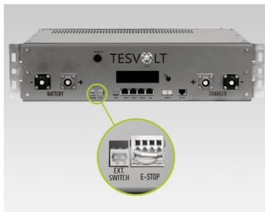
Anschluss E-Stop 4 an der APU HV1000-S mit Wago-Stecker
