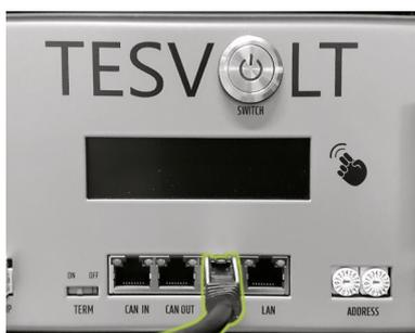
Conecte a conexão CAN SMA 7 do APU LV com a conexão ComSync IN do SMA Sunny Island por meio de um cabo de remendo 5.3.
