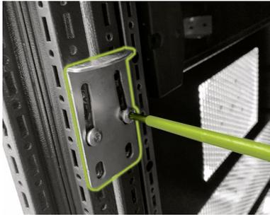
**Apenas extensão de armário TS:** Agora você pode montar um total de seis conectores de armários (K.1), para conectar as metades do armário. Os conectores de armários são fixados aos perfis da estrutura vertical do armário abaixo, no meio e acima. Primeiro, fixe dois parafusos de cabeça chata ST5,5 x 13 (K.2) nos orifícios alongados que correm obliquamente, com a extremidade angular do conector de armários apontando para cima. No início, aperte os parafusos apenas com a mão.
