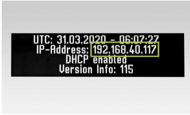
Toque no APU mestre ao lado do visor novamente para acessar o próximo item do menu. Você verá agora o endereço IP atribuído, desde que a conexão LAN do APU LV **8** esteja conectada a um roteador compatível com DHCP.
