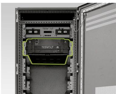
Coloque o primeiro módulo de bateria abaixo do APU LV nos trilhos deslizantes. Prenda-o às porcas gaiola pré-montadas usando quatro parafusos de cabeça chata M6 x 16 (D) (Phillips) (D.1) incluindo arruelas planas de plástico.
