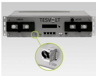
Conexão da parada de emergência 3 no APU LV com conector Wago com ponte entre os contatos 1 e 2
