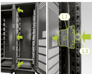
**Apenas extensão de armário do armário VX:** Primeiro conecte três conectores de armários à frente do armário (L1) nos perfis centrais verticais do armário no interior do armário na parte superior, no meio e na parte inferior. Cada um dos conectores de armários está equipado com dois parafusos sem cabeça parcialmente roscados M6 x 35 (L3) afixados ao lado dos perfis à estrutura da direita e esquerda. Primeiro aperte os parafusos apenas frouxamente.
