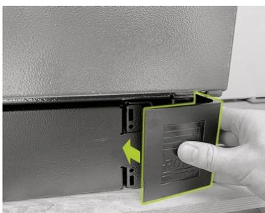
Agora você pode montar os painéis de canto da base (C)/(C.1). Os painéis se encaixam nos cantos da base do armário. O logotipo na respectiva base deve apontar para a frente na frente do armário e para a parte traseira na parte de trás do armário.
