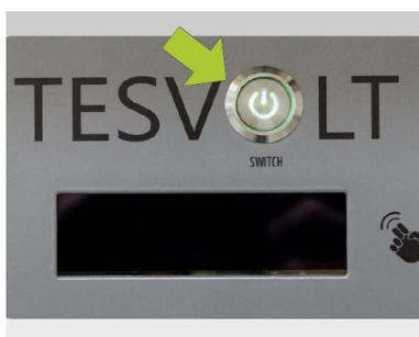
Desligue a bateria (acionando o interruptor aceso em verde liga/desliga no APU LV, o LED verde deverá apagar).
