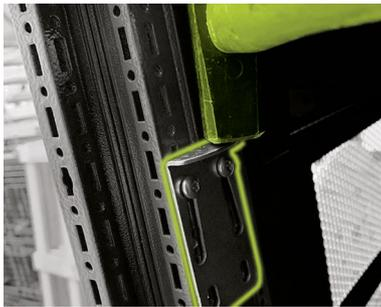
**Apenas extensão de armário TS:** Após todos os conectores de armários terem sido pré-montados, use um martelo para bater com cuidado nos conectores de armários alternadamente, empurrando-os para baixo. Isso reduz a distância entre os parafusos e as metades do armário são unidas. Pare quando os dois parafusos de cabeça chata ST5,5 x 13 (K.2) estiverem no topo dos orifícios alongados do conector de armários. Agora aperte os dois parafusos de cabeça chata com firmeza.
