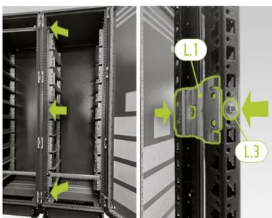
**Uniquement l'extension de l'armoire VX :** tout d'abord, sur l'avant de l'armoire, fixez trois connecteurs en baie (L1) sur les profilés verticaux centraux de la face intérieure de l'armoire en bas, au milieu et en haut. Les connecteurs en baie sont fixés aux profilés de cadre de chaque côté à droite et à gauche avec à chaque fois deux vis sans tête M6 x 35 (L3). Ne serrez que légèrement les vis au début.
