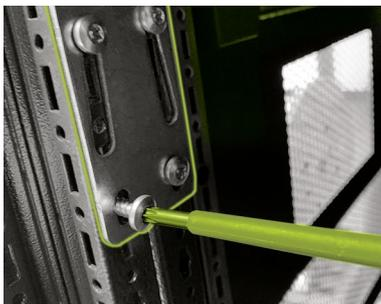
**Uniquement l'extension de TS :** insérez deux vis à tête plate supplémentaires ST5,5 x 13 (K.2) dans les petits trous du connecteur en baie.
