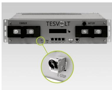
Connexion E-Stop ③ sur l'APU LV avec fiche Wago et pont entre les contacts 1 et 2
