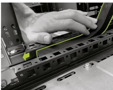
**Uniquement l'extension de l'armoire TS-/VX – en option :** La bande d'étanchéité (M5) peut être appliquée dans l'espace entre le cadre de l'armoire sur les surfaces de butée. Utilisez la face auto-adhésive de la bande d'étanchéité pour la fixer à l'une des surfaces de butée des armoires (profilés de cadre). La bande d'étanchéité est purement esthétique et n'a pas d'utilité fonctionnelle.
