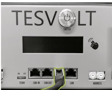
Reliez le raccord CAN SMA (7) de l'APU LV au raccord ComSync IN du SMA Sunny Island au moyen d'un câble patch (5.3).
