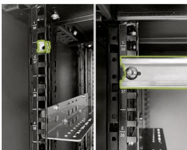
**Uniquement armoire TS :** installez le rail C (B) au-dessus de la position de l'APU LV. Pour ce faire, commencez par monter deux écrous cage (E) au moyen de l'outil auxiliaire (E.1) dans le quatrième trou en partant du haut, dans les deux rails de rack. Fixez-y le rail C avec deux vis à tête plate M6 x 16 (D) (avec fente cruciforme) et deux rondelles en plastique (D.1).
