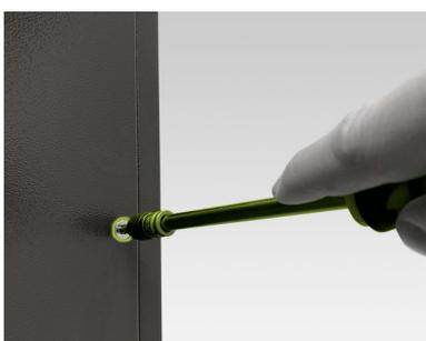
La première étape consiste à démonter les panneaux latéraux des montants d'armoire qui relient les armoires entre elles.
