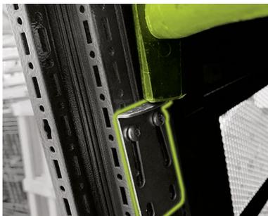
**Uniquement l'extension de TS :** une fois tous les connecteurs en baie prémontés, enfoncez avec précaution chacun d'entre eux à l'aide d'un marteau pour les faire glisser vers le bas. Ainsi, la distance entre les vis sera réduite et les deux moitiés de l'armoire seront rapprochées l'une de l'autre. Arrêtez-vous lorsque les deux vis à tête plate ST5,5 x 13 (K.2) affleurent l'extrémité supérieure des trous oblongs du connecteur en baie. Maintenant, serrez complètement les deux vis à tête plate.
