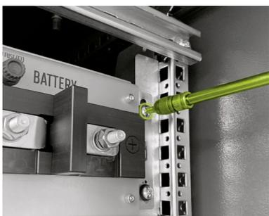
Placez l'APU LV sur la glissière la plus en haut. Aux quatre points de fixation, fixez les vis à tête plate M6 x 16 D (D) incluses dans le pack (cruciforme) avec les rondelles en plastique (D.1) sur les écrous cage préinstallés.
