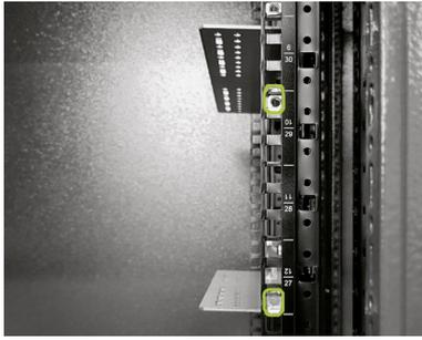
**Uniquement armoire TS :** montez maintenant les écrous cage (E) pour fixer les modules de batteries (Z) à l'aide de l'outil auxiliaire (E.1). Répartissez les écrous cage de bas en haut. Commencez par le bord inférieur de la glissière du module de batterie concerné. Insérez les deux premiers écrous cage des deux côtés dans l'ouverture directement au-dessus, laissez les sept ouvertures suivantes vides et insérez une autre paire d'écrous cage dans l'ouverture suivante dans les deux rails du rack.
