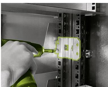
**Uniquement l'extension de l'armoire VX :** fixez les connecteurs en baie central et supérieur sur les trous de la façade avant à l'aide de quatre vis à tête plate ST5,5 x 13 (L2). Remontez ensuite la glissière correspondante.
