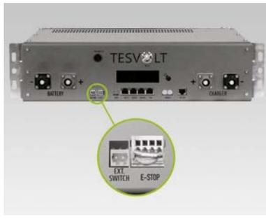
Conexión de parada de emergencia 4 en la APU HV1000-S con enchufe Wago.
