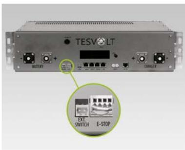
Para que funcione, se debe conectar a la APU HV1000-S el enchufe de cuatro clavijas de la parada de emergencia. Sin este enchufe, la APU HV1000-S seguirá desconectada. Encontrará más información sobre la parada de emergencia en el apartado "8.3 Contacto de parada de emergencia" en la página 45.
