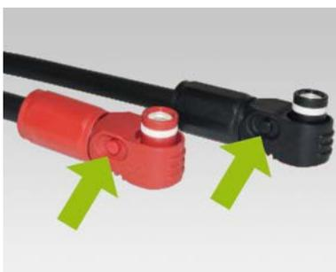
Tenga en cuenta lo siguiente a la hora de instalar la interconexión de CC: **las clavijas deben hacer un clic audible al encajarlas.** Las clavijas se pueden desbloquear al presionar en el botón del lateral de la clavija (véanse las flechas de la imagen).
