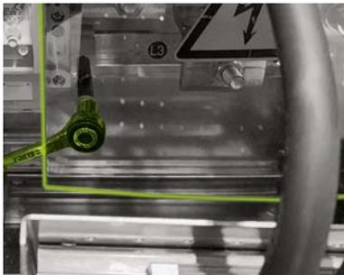
A continuación, quite el protector táctil situado encima de las conexiones de CC (26). Para ello, afloje los dos tornillos M6 y quite el protector táctil.
