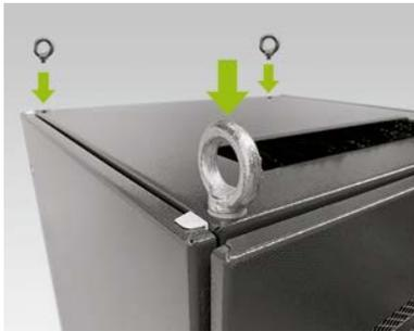
**Opcional: Instalar los tornillos con argolla:** para transportar cada una de las mitades del armario con una grúa, instale cuatro tornillos con argolla en las cuatro esquinas de cada mitad del armario. Para ello, retire los tornillos de fijación de la tapa de los armarios y colo que en su lugar tornillos con argollas (L).
