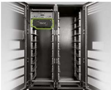
Inserte el primer módulo de batería en los carriles de deslizamiento debajo de la APU HV1000-S. Fíjelo a las tuercas enjauladas instaladas de fábricas con ayuda de tornillos de cabeza plana M6 x 16 (I) (Phillips) incl. las arandelas de plástico (I.1). A continuación, coloque el resto de módulos en la mitad izquierda del armario.
