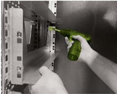
Ahora, coloque los tres herraje de montaje restantes (H) en los perfiles del armario, en la parte trasera del mismo, y a la misma altura que los herrajes de montaje que se han fijado en la parte frontal. Siga el mismo procedimiento del montaje en los perfiles frontales del armario para montar el herraje de montaje inferior. En cambio, para los herrajes de montaje de la parte central y superior del armario, deberá quitar primero el carril de deslizamiento de un lateral en la zona de montaje.
