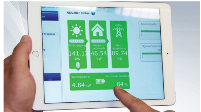
Anlagenüberwachung durch SMA Sunny Portal
